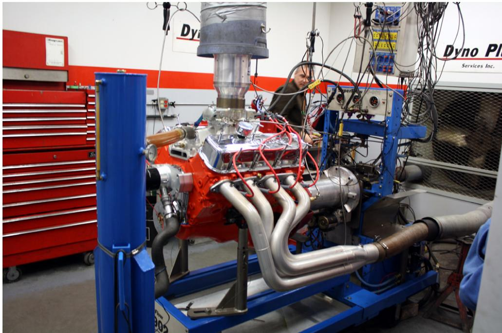
Figura 20: Motor en un banco de pruebas conectado al dinamómetro (*Dyno Plus*).
