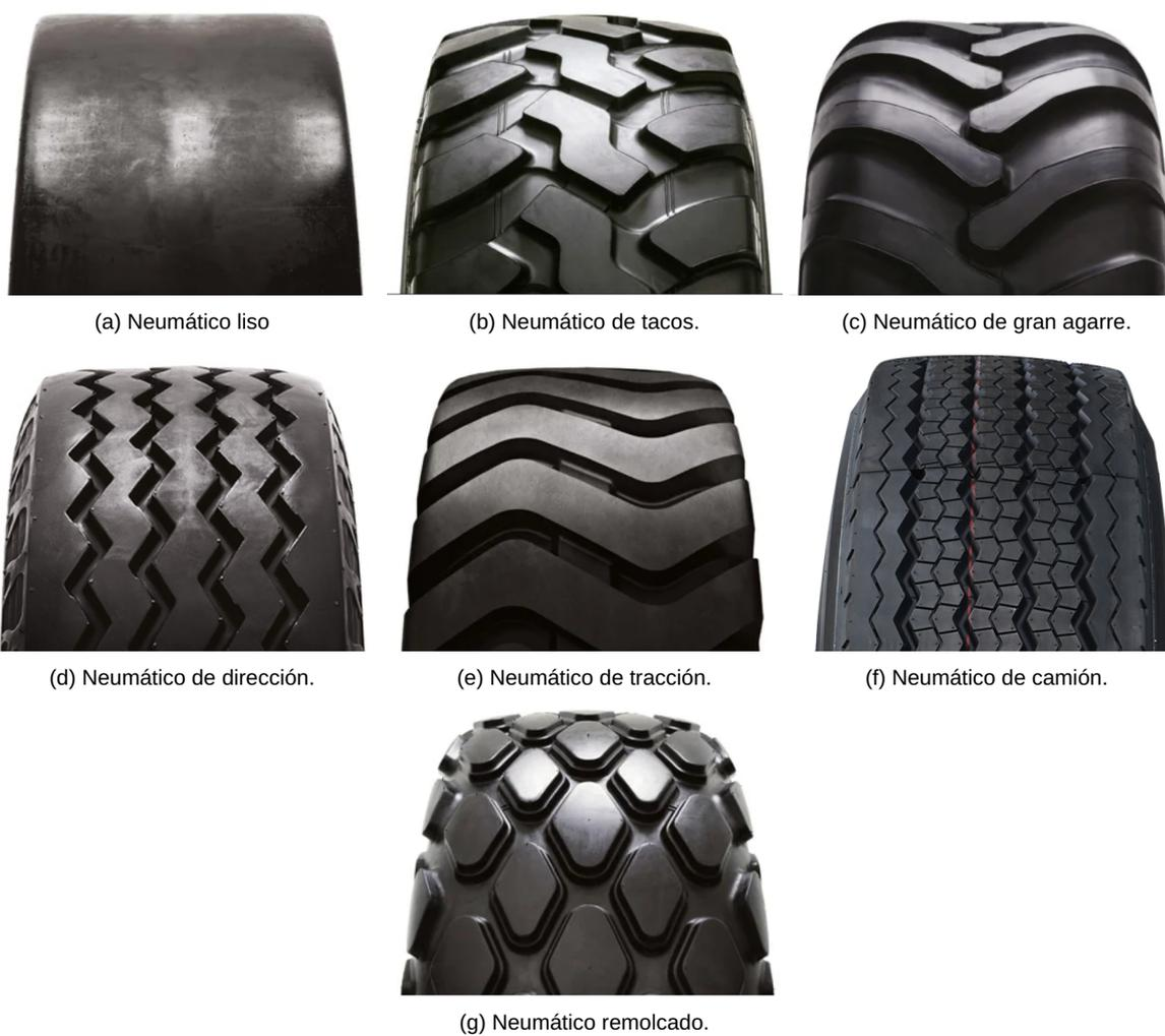
Figura 31: Tipos de acanaladuras en neumáticos.
