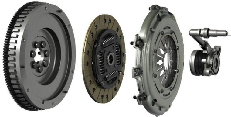
Figura 23: Los tres discos de un embrague (*Diariomotor*).
