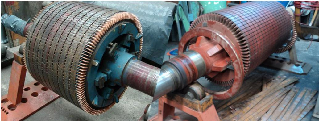
Figura 5: Rotor en jaula de ardilla (M&E Ingeniería Mecánica Eléctrica)
